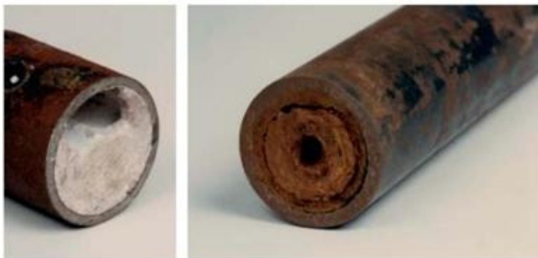
Figure N°3 : Le phénomène de l'entartrage
