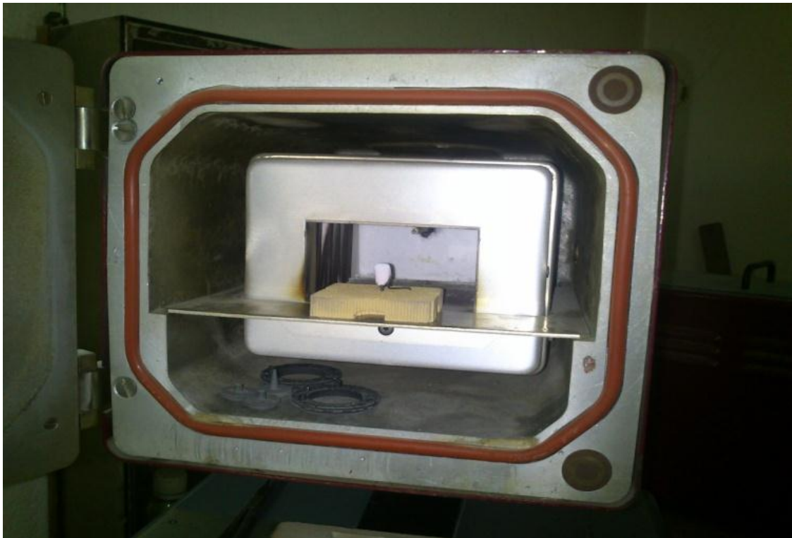
Figure III.16 : séchage à l'entrée du four.
