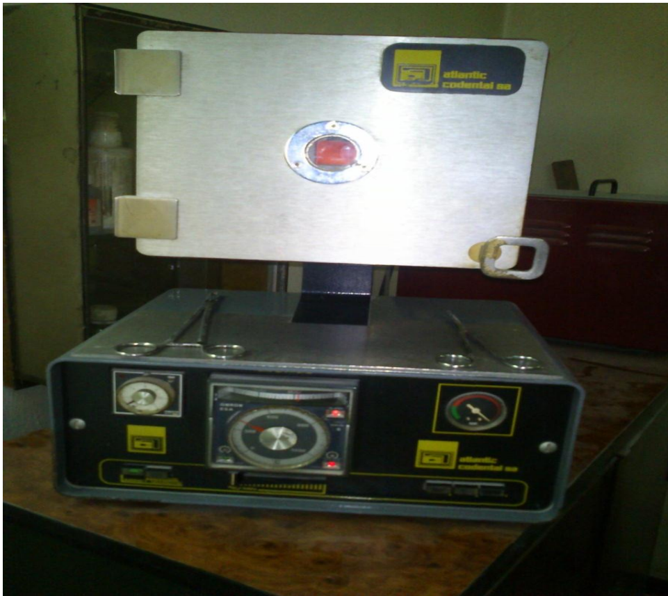
Figure III.17 : cuisson de l'opaque.
