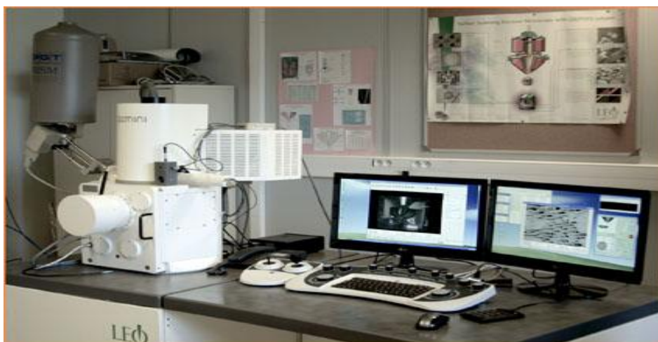
Figure II.9 : microscope électronique à balayage menu d'un système d'acquisition EDS [32]
