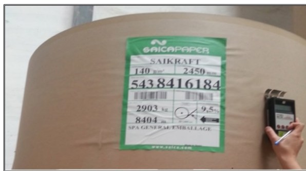
Figure 21 : Principe de détermination de la teneur en humidité sur la bobine.
