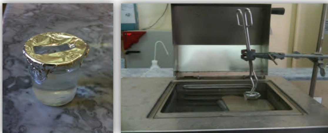
Fig.23. Premier montage expérimental utilisé pour le dépôt de ZnS.
