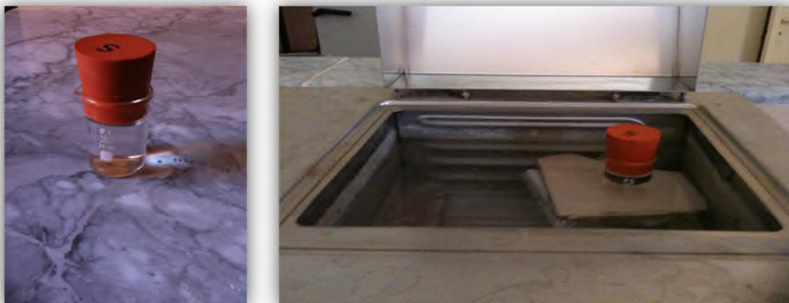
Fig.24. Deuxième montage expérimental utilisé pour le dépôt de ZnS.
