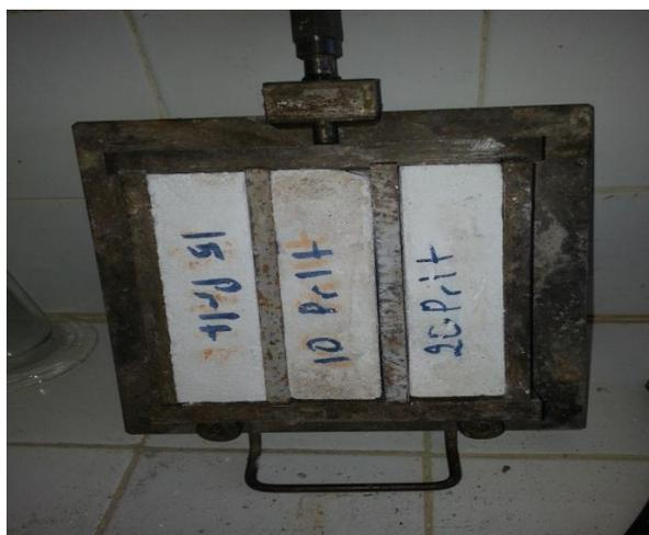
Figure 30 : confection des éprouvettes
