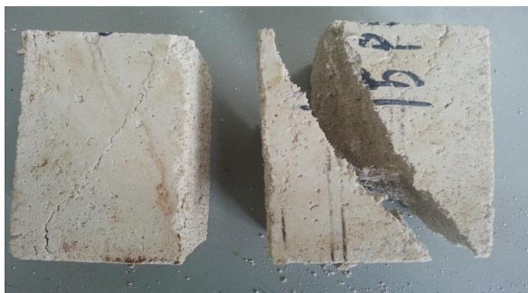
Figure 26: rupture d'un quart d'éprouvette
