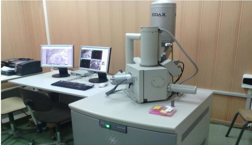
Figure 15 :Le microscope utilisé pour visualiser la morphologie de nos échantillons, de type FEI Quanta 200 qui a un détecteur GSED.
