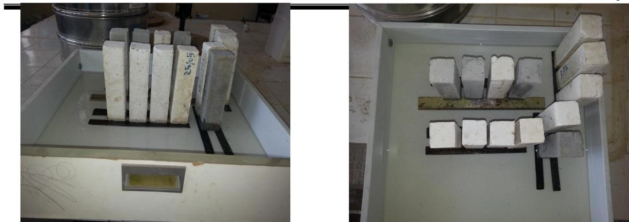
Figure 31 : dispositif de la détermination de l'absorption d'eau par capillarité
