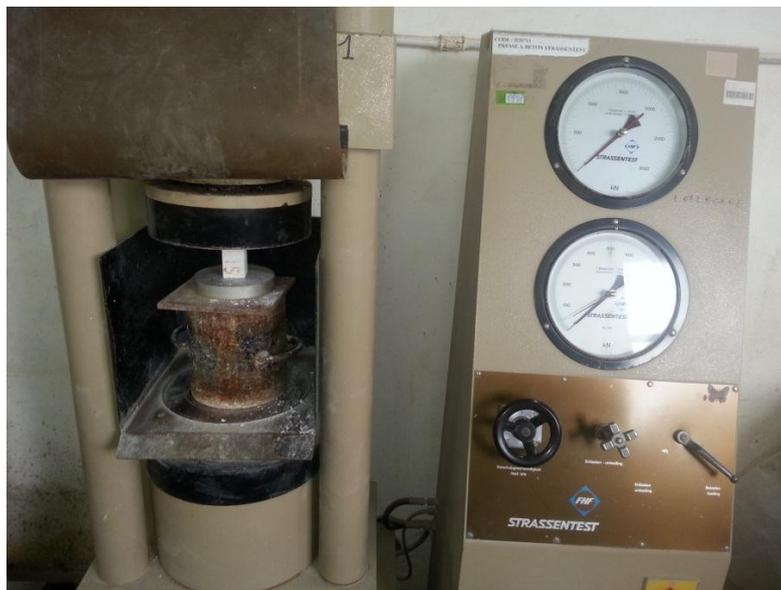
Figure 25 : dispositif d'essai de la résistance à la compression
