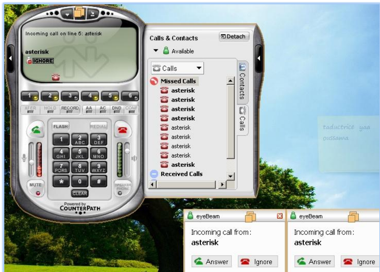
Figure 5.23 : invite flood attaque sur le client SIP
