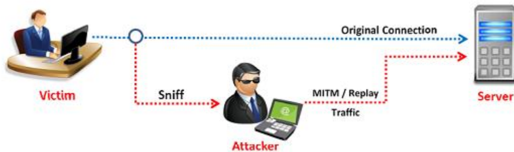
Figure 3-2: exemple de sniffing d'une communication client serveur
