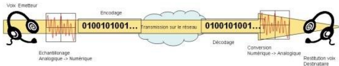
Figure 2.1: principe de la voix sur IP
