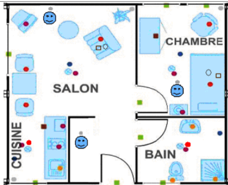
FIGURE 3.8 – Système de capteur du domicile de la personne dépendante.
