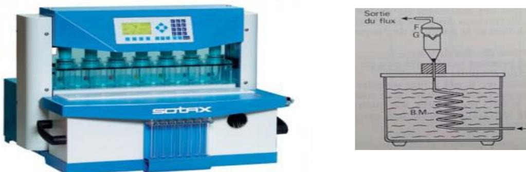
Figure III.4 : Appareil à flux continu
