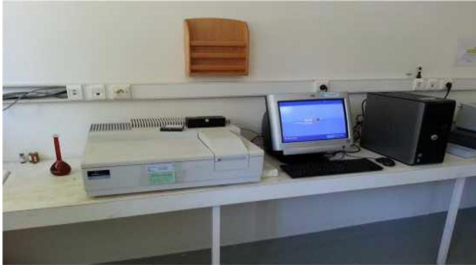
**Figure IV.2 :** Spectrophotomètre UV-Visible marque Perkin Elmer
