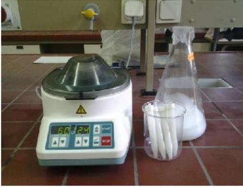
**Centrifugeuse à 600tr/min**
