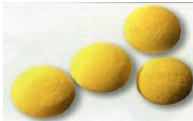
b : Surmouillage et érosion du noyau
