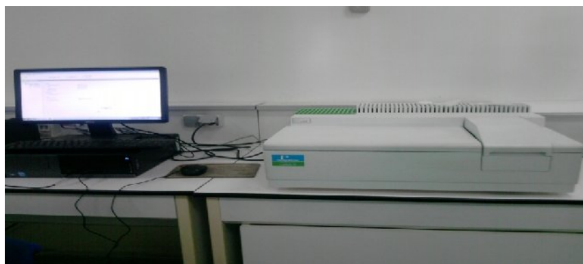
Figure 14 : Spectrophotomètre UV-Visible de marque LAMBDA
