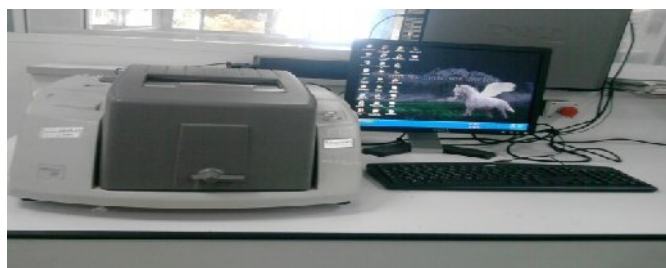
Figure 12 : Spectrophotomètre à transformée de fourrier de marque NICOLET 380FT-IF.
