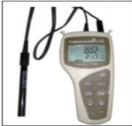
**Fig. IV. 4:** Appareil de mesure de conductivité volumique (Conductimètre)
