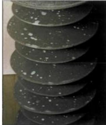
**Fig. I. 1:** Isolateur composite en silicone trempé dans le sel (NaCl) et de kaolin
