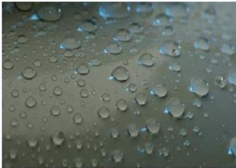
**Fig. II.6 :** hydrophobicité d'une surface en silicone [28]
