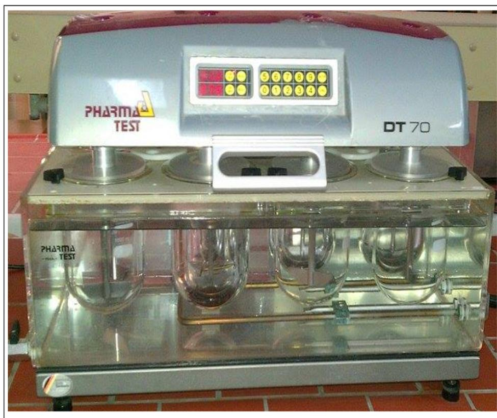
FIGURE 5.15 – Appareil de dissolution à pale tournantes
