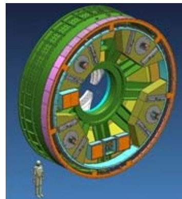
Fig.I.6 : Le plus grand générateur à aimant permanent et entraînement direct au monde destiné à une éolienne [15]
