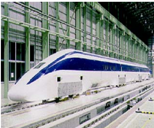
Fig.I.1 : Maglev japonais MLX01 à voie active, prévision de vitesse commerciale 500km/h [11]
