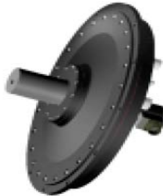
Fig.I.16 : Moteur à aimants à champ axial (Lynx Motion Technology Corp. T468) T_{max}=1350\text{N.m} P_{max}=35\text{kW} , 58kg (27N.m/kg) [11]
