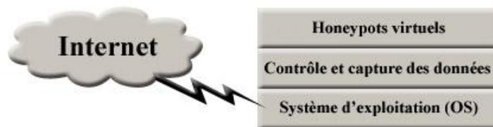
FIG. 1.6 – Architecture d'un *honeynet* purement virtuel
