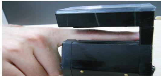
**Figure II. 4:** *Appareil de capture des veines du doigt*
