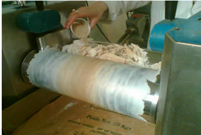
Figure 7 : Photo de la préparation des films de composites par calandrage.
