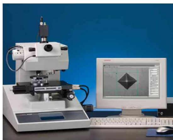
Figure III.13 : Système de test de microdureté, contrôlé par PC et logiciel pour une plus grande répétabilité. Avec changement de charges automatique.
