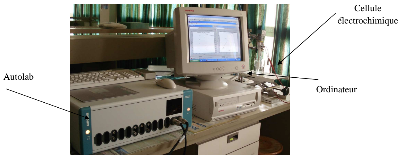
Figure III.11 : Photo du dispositif expérimental pour la mesure des impédances
