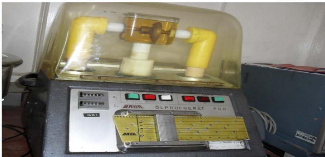
Figure 18: Photo de l'appareil de mesure de tension de claquage.
