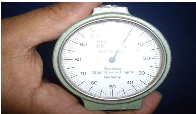
**Figure 16 :** Photo du duromètre shore D.
