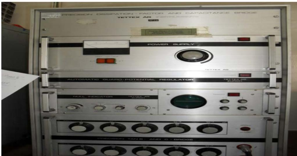
**Figure 19:** Photo de l'appareil de mesure de capacité et les pertes diélectriques.
