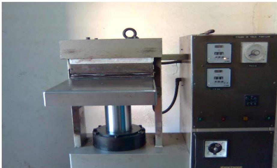
**Figure 10 :** Photo de la presse à table utilisée.
