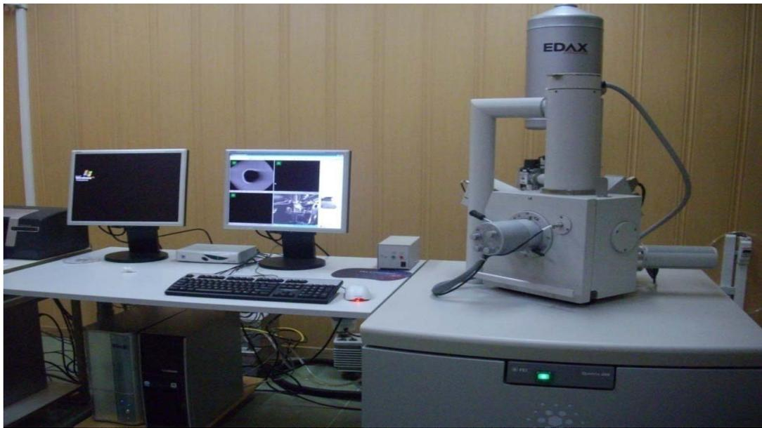
**Figure 20** : Photo de l'appareil (MEB).
