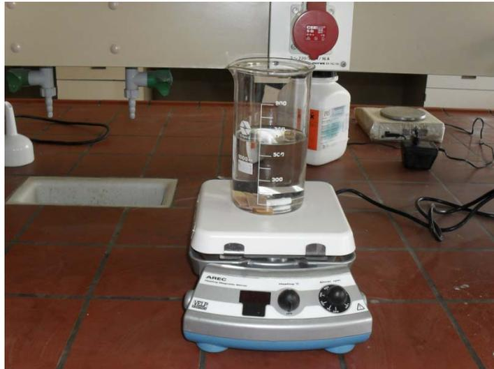
**Figure 13** : Photo du test d'absorption d'eau.
