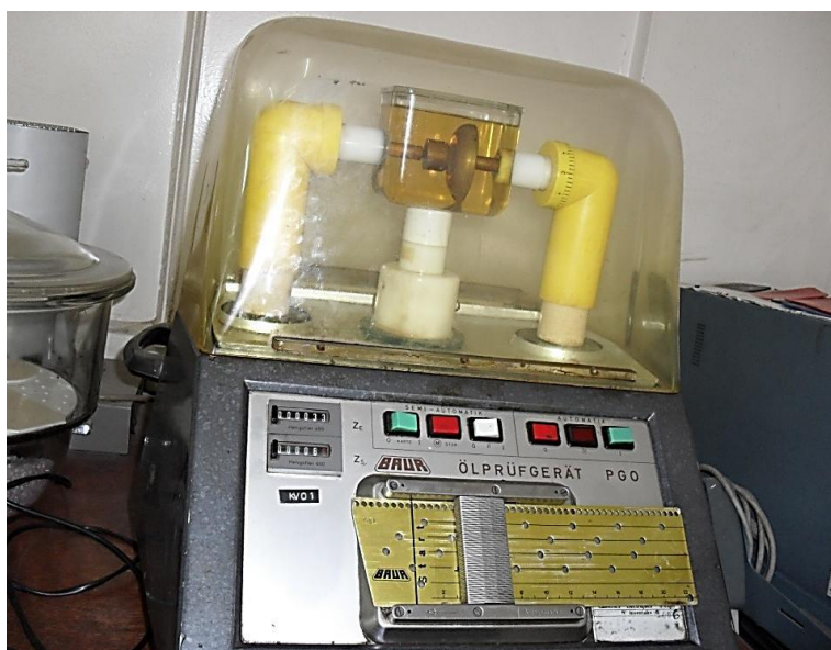
Figure III.3.7. Appareillage de mesure de la tension de claquage.
