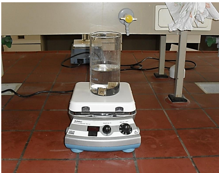
Figure III.3.2. Photo du test d'absorption d'eau.
