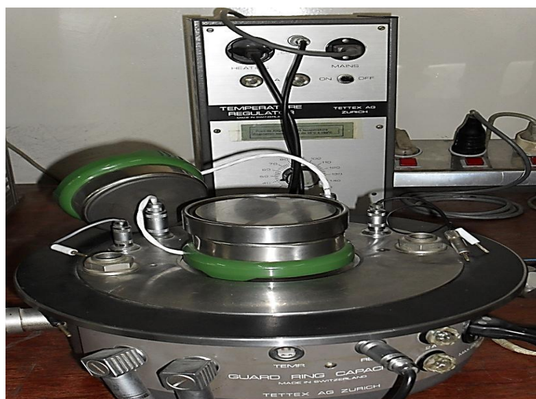
Figure III.3.8. Photo de la cellule de mesure des propriétés diélectriques.
