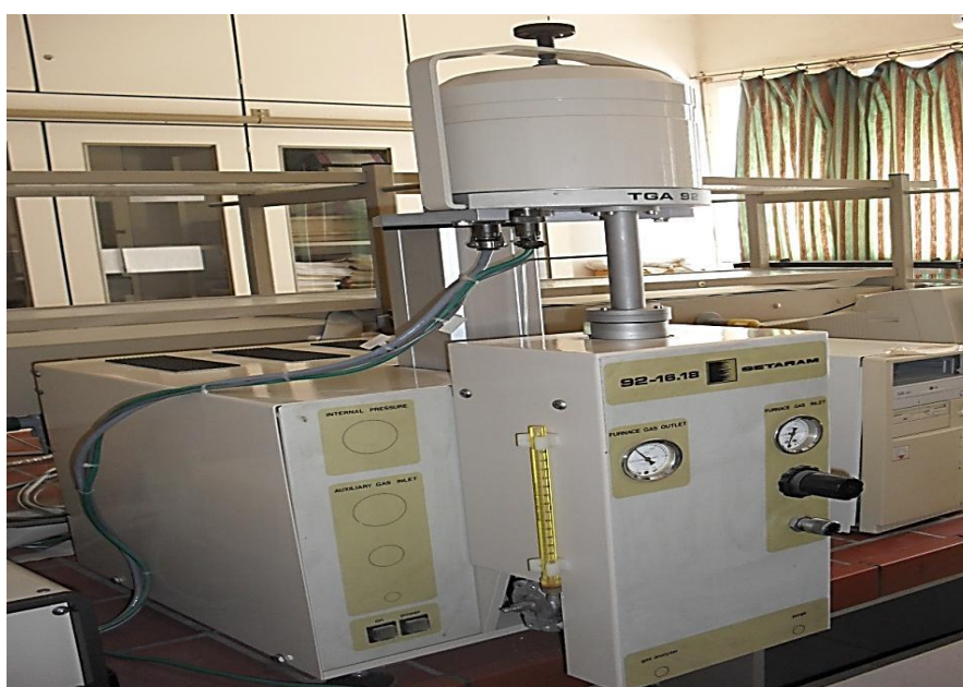
Figure III.3.5. Photo du four de l'appareillage de l'analyse thermogravimétrique.
