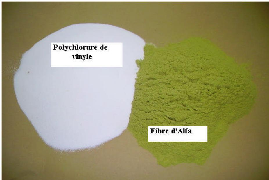
*Figure. 8:* Poudres du polychlorure de vinyle et de la fibre d'Alfa tamisé
