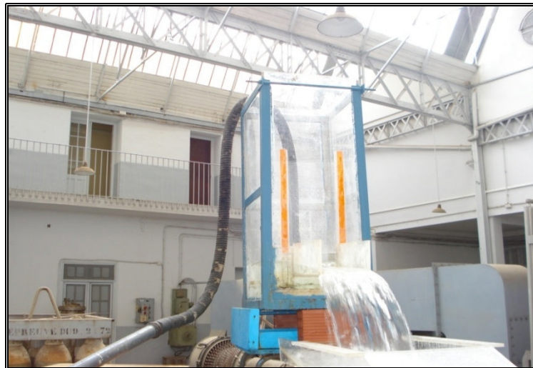
Photographie III.2 : Réservoir d'alimentation
