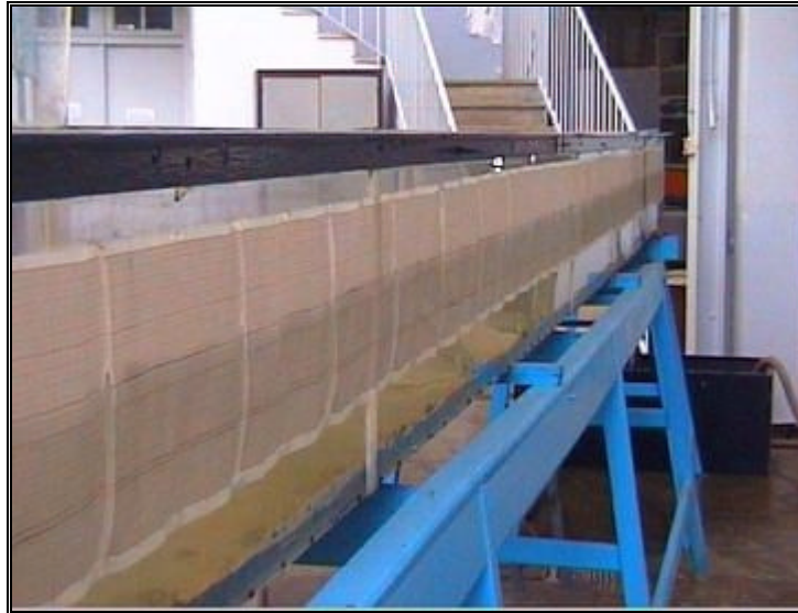
Photographie III.6 : Dispositif de mesure de la hauteur d'eau (Papier millimétré).
