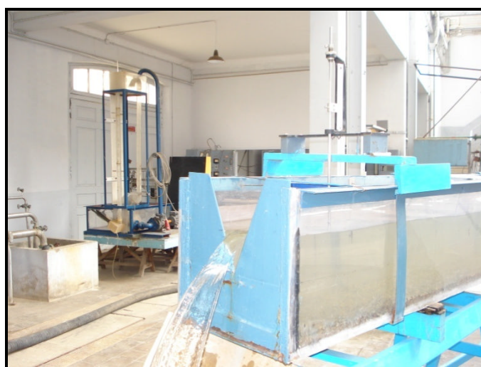
Photographie III.5 : Déversoir triangulaire
