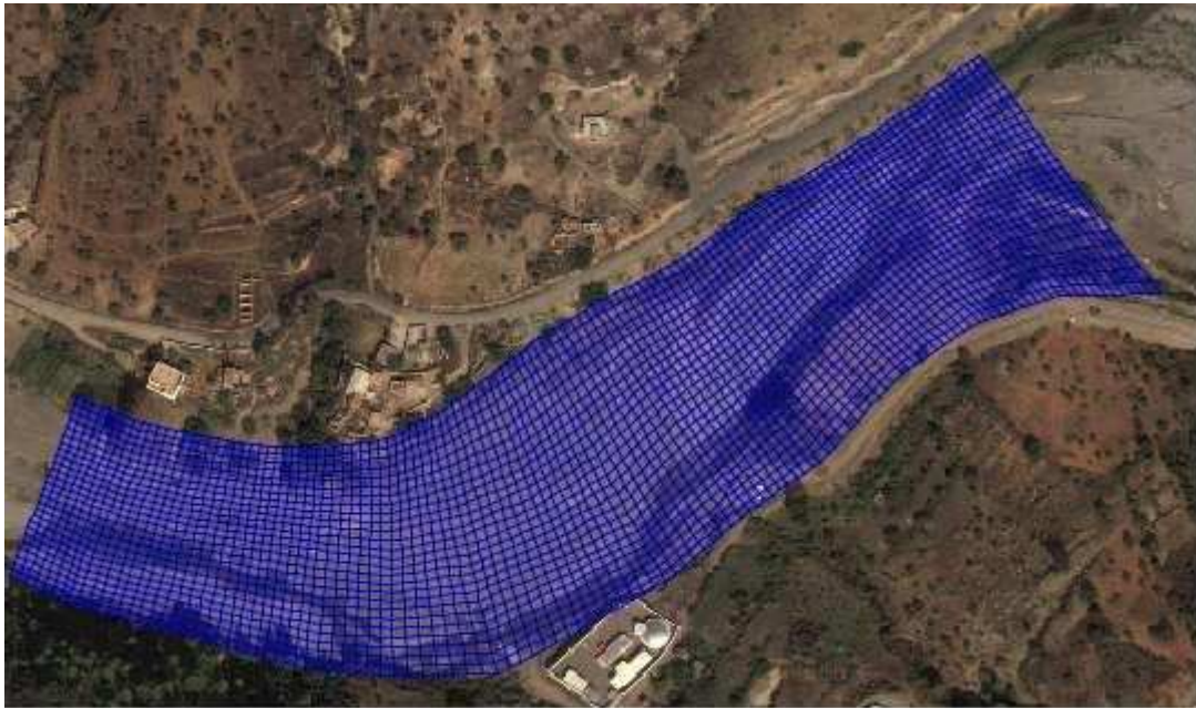
Figure V.14 : Maillage du tronçon sur Oued Boussellam
