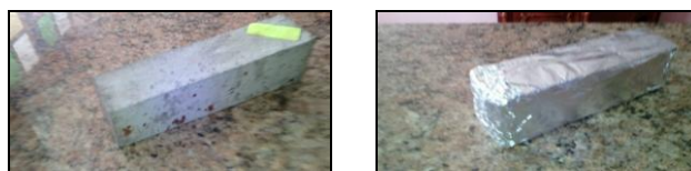
Figure II.4 : Eprouvettes 4*4*16 cm 3 confectionnées de type mortier.
