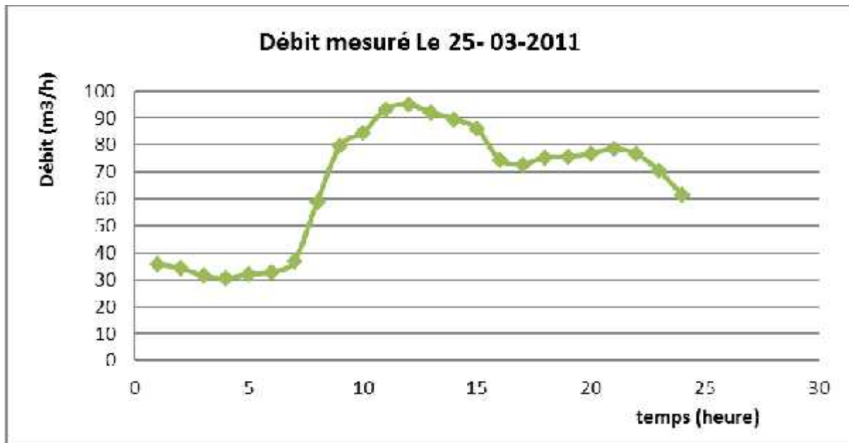
Figure 5.3 : Débit mesuré Le 25-03-2011 à la sortie du réservoir de Bologhine.
