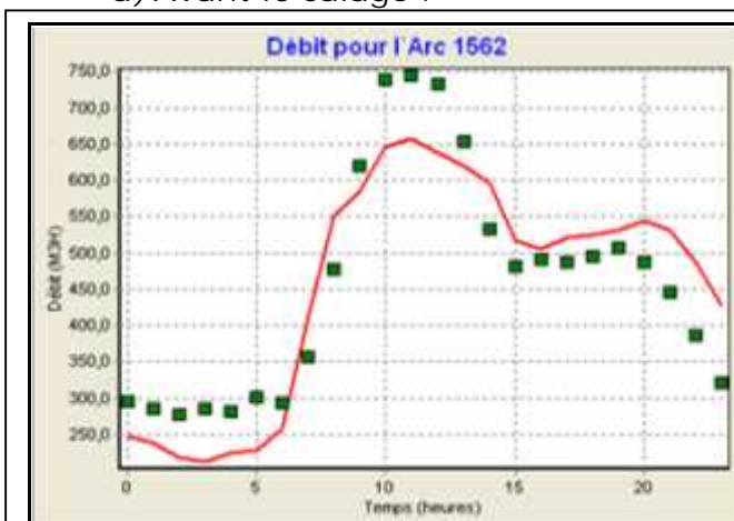
Figure 5.6 : Comparaison des débits de consommation totale mesurés et calculés (simulés par le modèle) avant le calage.
