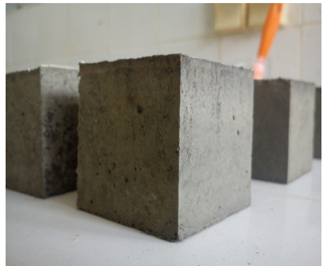
Figure III.4 : éprouvettes de mortier cubique de dimension (40*40*40) mm 3
