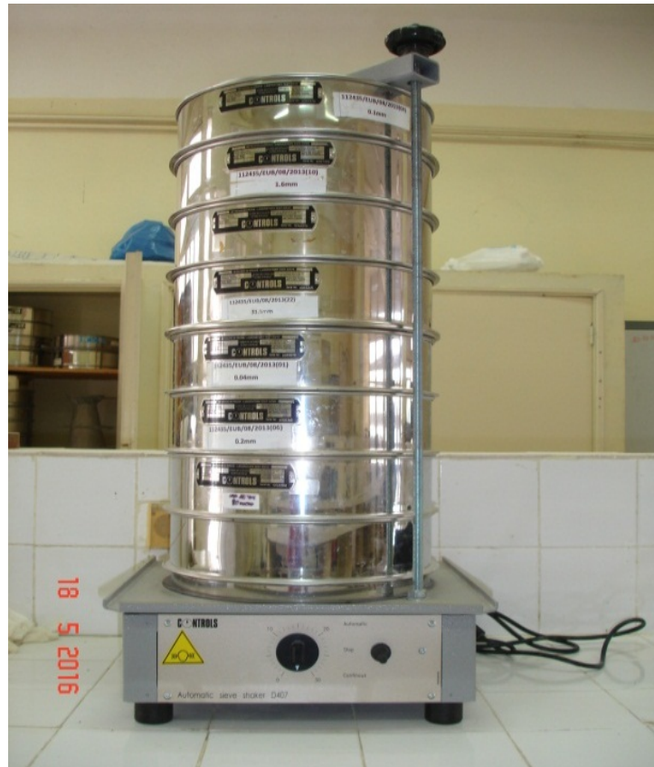
Figure.II.3 : Tamiseur électrique et une colonne de tamis (laboratoire de génie civil université de Bejaia)
