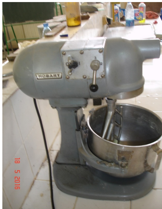
Figure III.1 : Malaxeur de capacité de 5 litre (laboratoire de génie civil .Bejaia)
