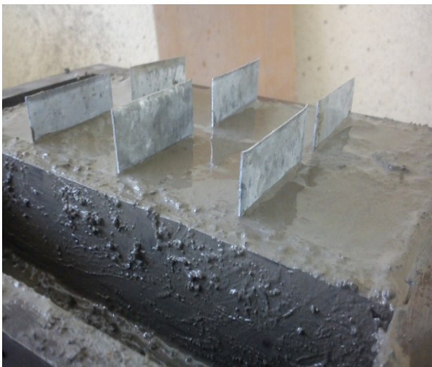
Figure III.3 : séparation du mortier dans les moules avec des feuilles métalliques
