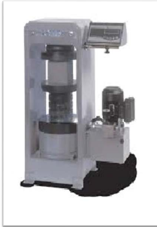
Figure III.6 : Presse hydraulique pour l'essai mécanique de la compression
