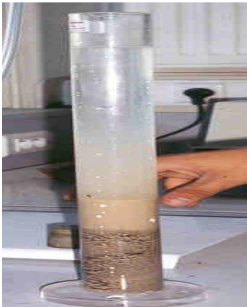
Figure.II.5 : Essai d'équivalent de sable.
