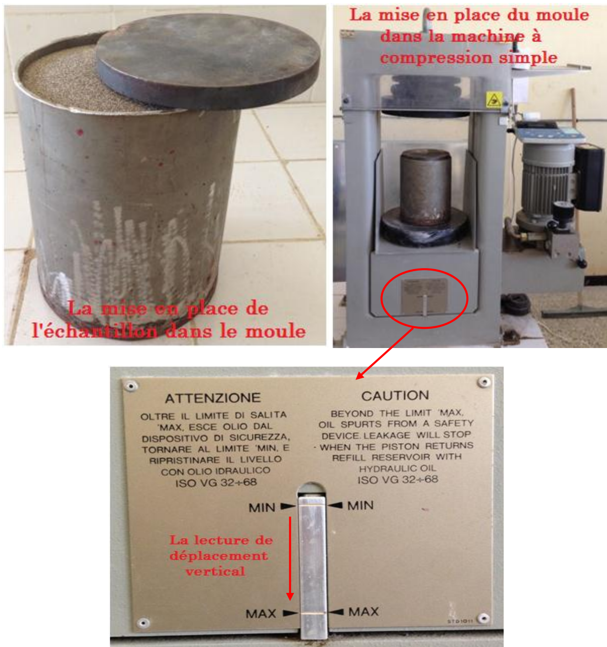
Figure 3.15. Diapositif et mise en place d'un échantillon pour chargement uniaxial
