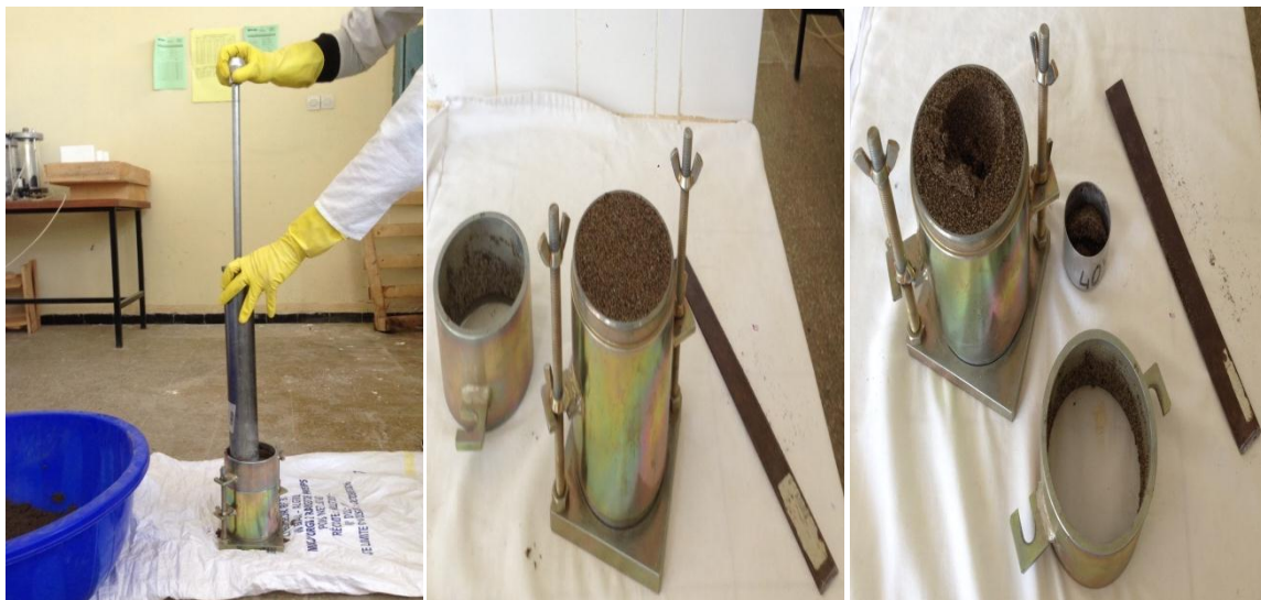
Figure 2.7. Déroulement de l'essai Proctor normal
