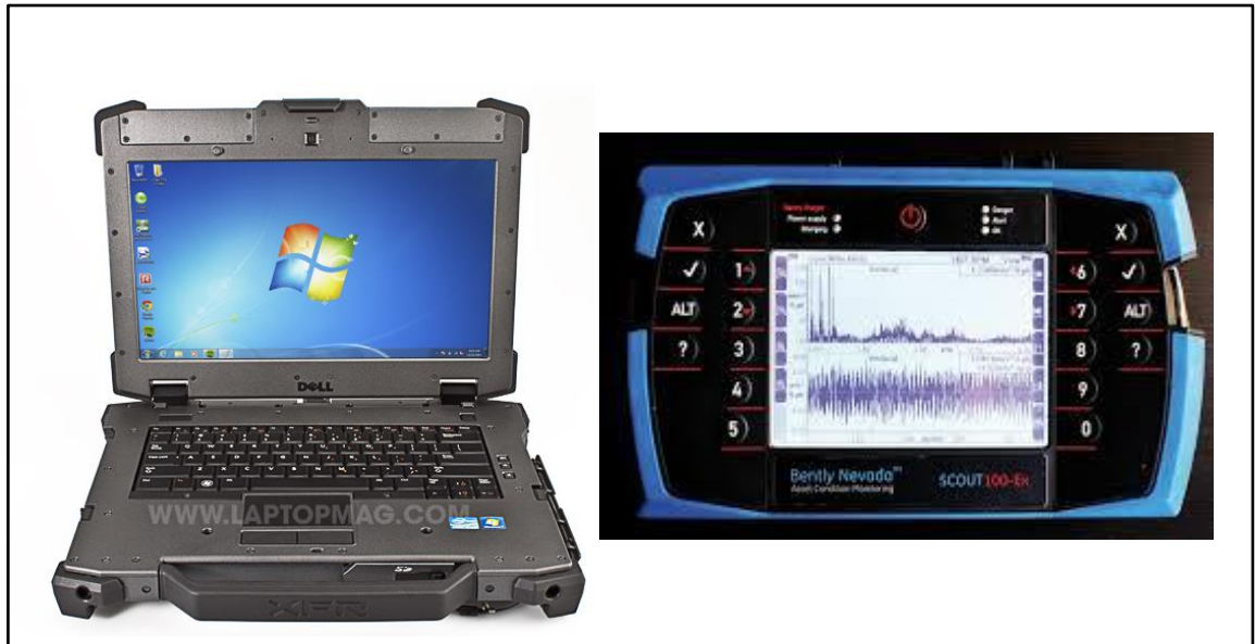
Figure V.7. Nevada ( Scout 100)ET le PC pour la lecture
