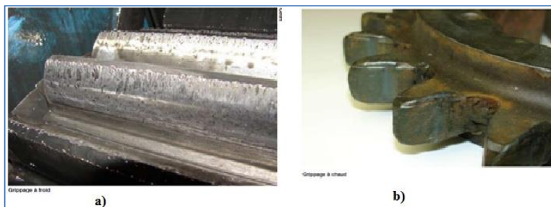
Figure II.10. Grippage a) à froid, b) à chaud [15]
