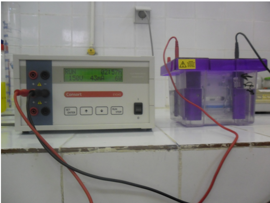
Figure 10 : Cuve et accessoires du dispositif d'électrophorèse (Thermo Scientific).
