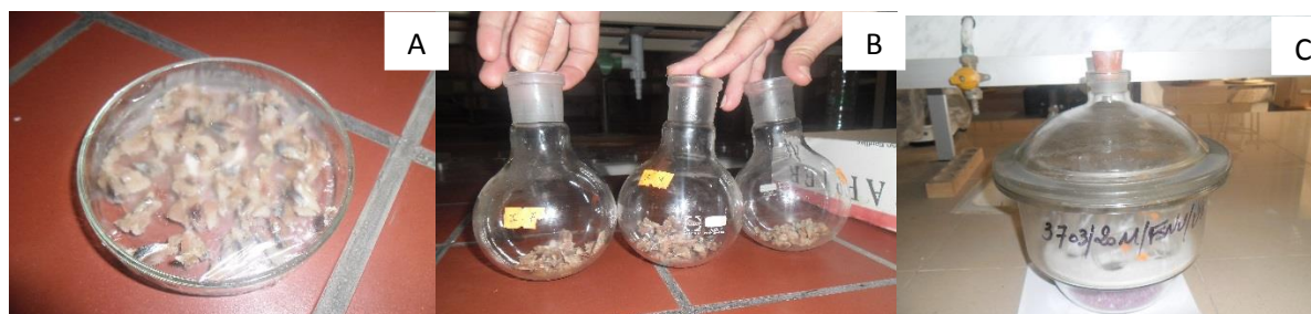
Figure 8 : A : Echantillon prêt pour la congélation, B : Echantillons prêt pour la lyophilisation, C : Echantillons prêt pour le broyage.
