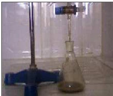
**Figure n°22** : Dosage des chlorures .
