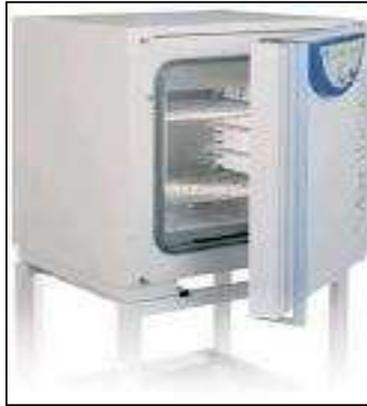
**Figure n°23:** Séchage des sédiments à 105°C.
