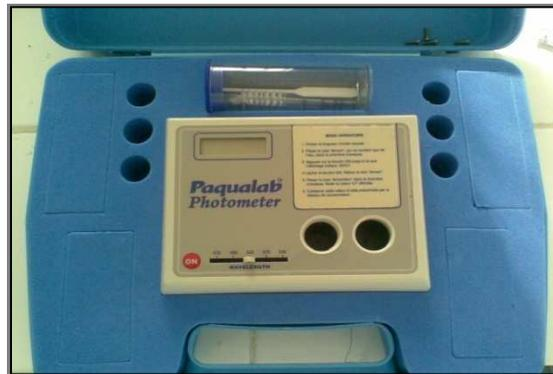
**Figure n° 19:** Photomètre utilisé pour le dosage des sels nutritifs.
