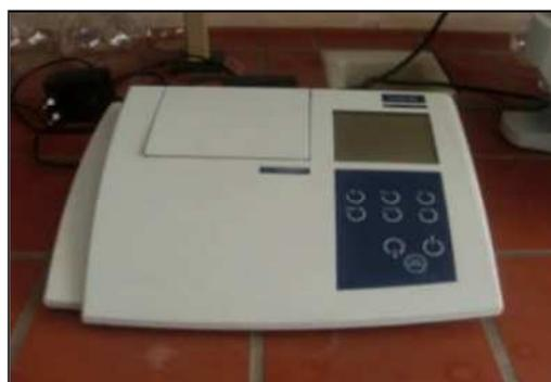
Figure n°18 : Oxymètre de paillasse.
