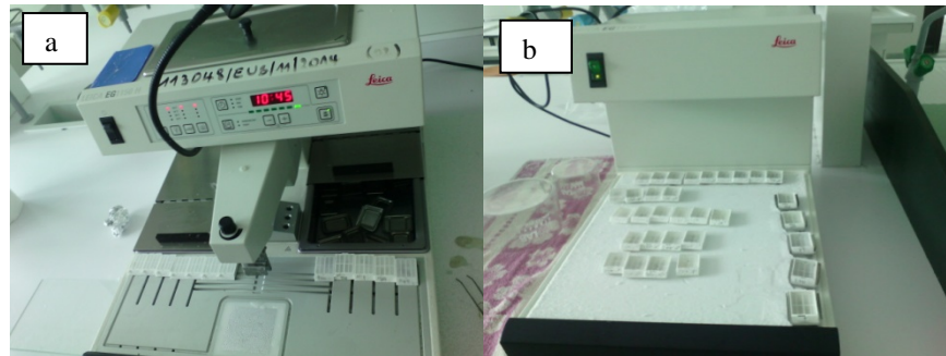
Figure 18: Enrobage des tissus et démoulage; a: la paraffine fondue; b: plaque réfrigérante
