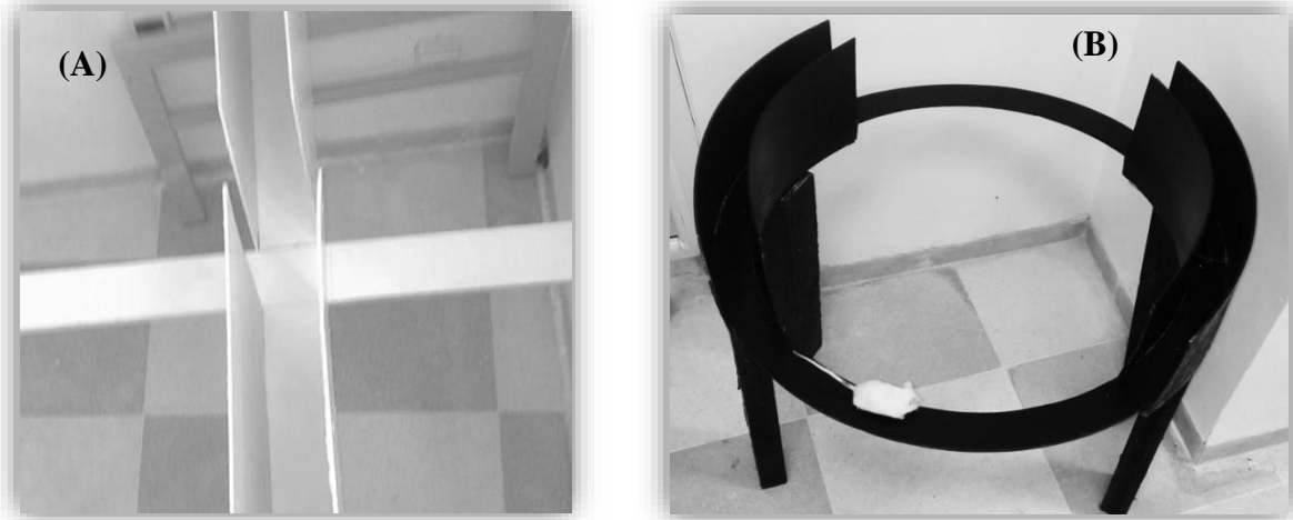
Figure 9 : Photographie originale des dispositifs (A) : Elevated plus maze . (B) : Elevated zero maze .
