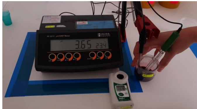
Figure 06 : Photographie représentant un exemple de mesure de pH et de Brix d'un fruit.
