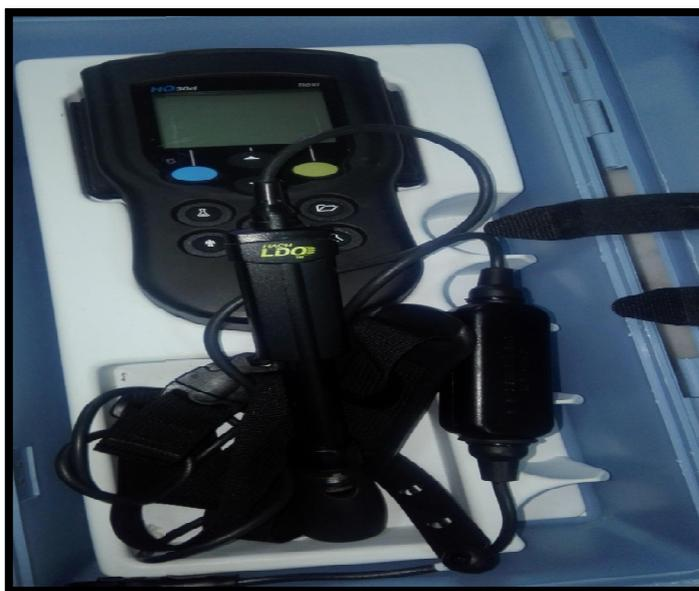
**Figure 4:** Oxymètre de laboratoire
