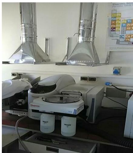
**Figure 16 :** Appareil de spectrométrie d'absorption atomique
