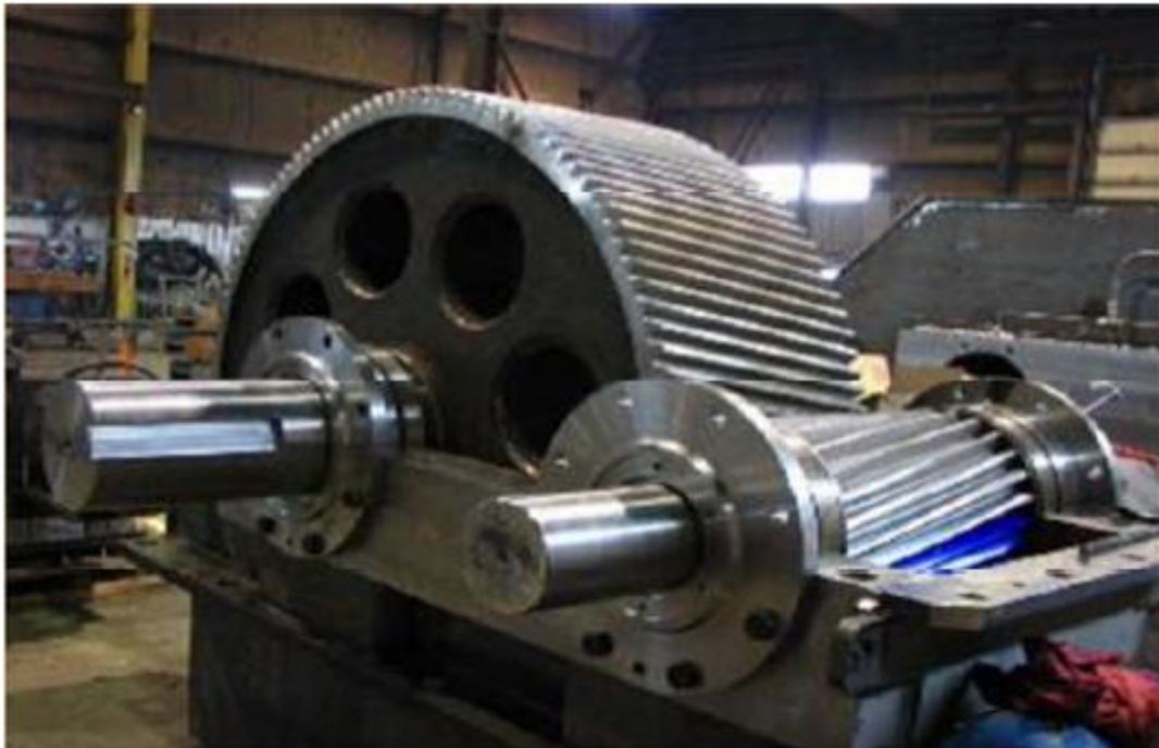
Figure I.5 : Schéma de la structure générale du réducteur à arbres parallèles [2].
