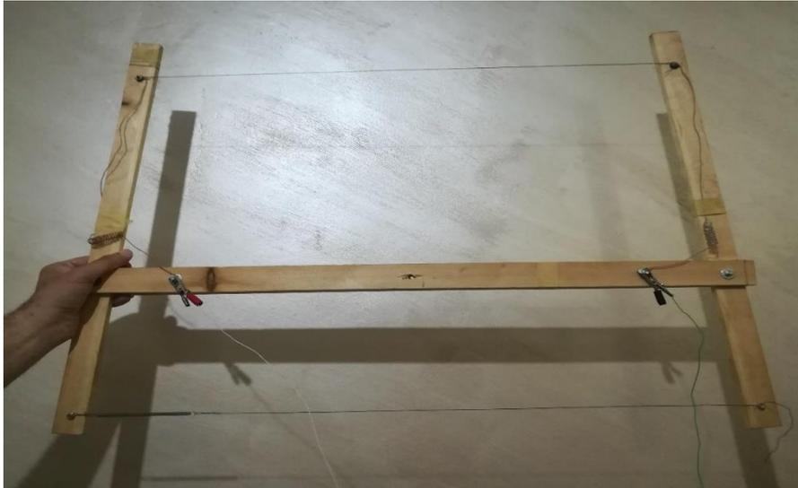
Figure III.6: coupe polystyrène à fil chaud
