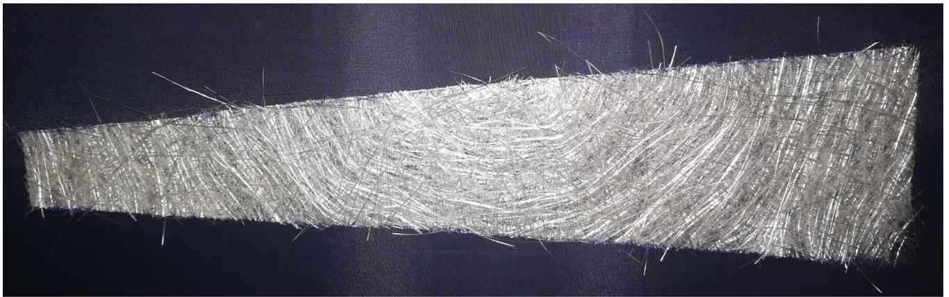
Figure III.32 : Feuille en fibre de verre découpée en forme trapèze
