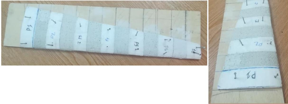
Figure III.30: Remplissage des vides entre chaque profil avec du plâtre
