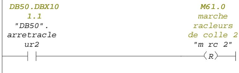
Réseau : 7      bornier machine s3/262-
