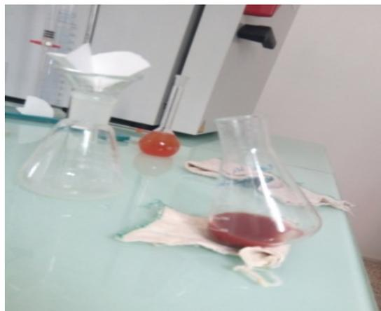
**Figure IV.4.** : Une photographie d'un erlinmeyer incliné pour déposition du précipité
