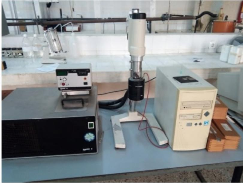
**Figure IV.9.** : Une photographie du viscosimètre de couette
