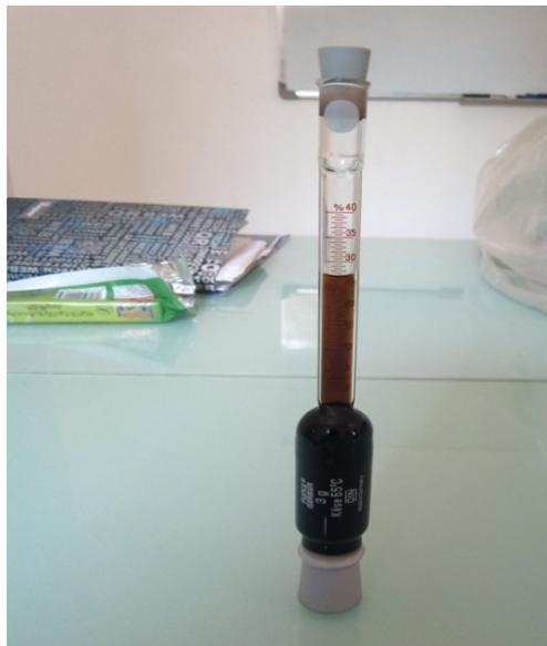
**Figure IV.6.** Une photographie d'un butyromètre rempli de la solution
