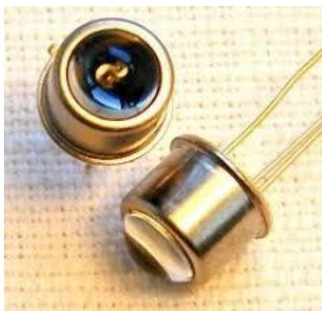
*Figure II.9 : photodiode [52]*
