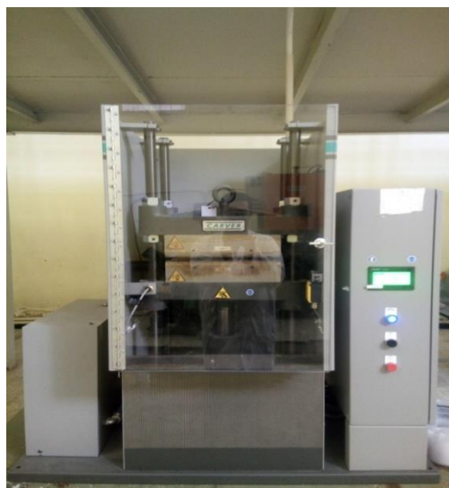
Figure III.5: Photo d'une presse hydraulique utilisée pour la préparation des plaques
