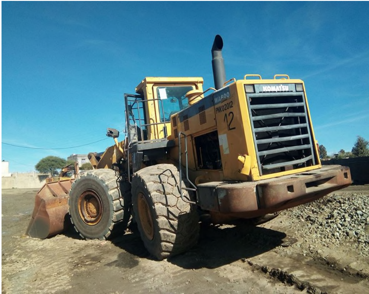
Figure III.2 : ChargeuseKOMATSU WA600-3. (Photo carrière ENG, février 2018).
