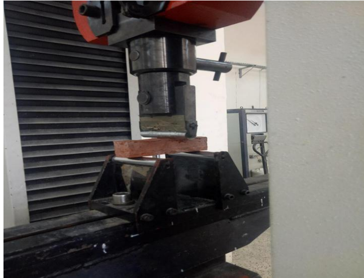
Figure III.15 Appareil de la résistance à la flexion (laboratoire génie civil université Tizi ouzou).
