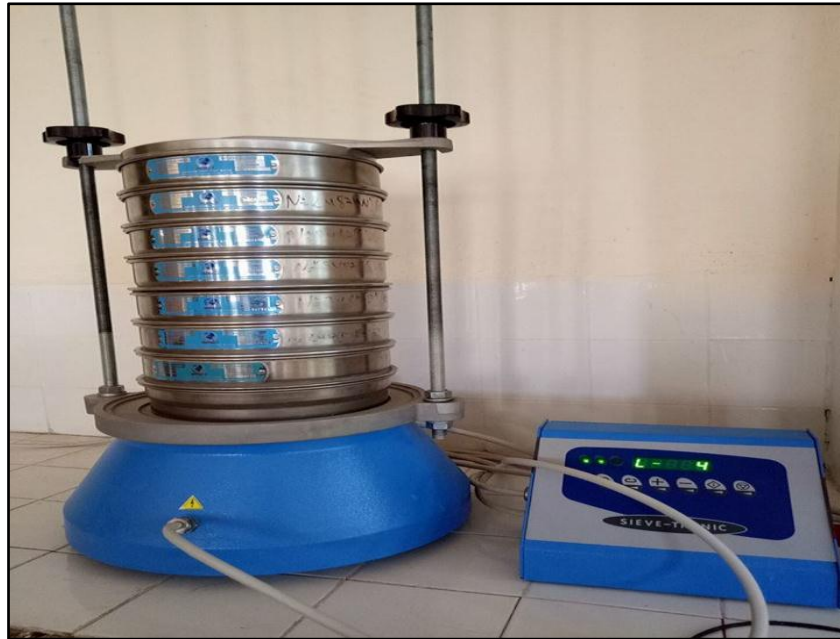
Figure III.1 Tamiseuse (laboratoire génie des procédés université Bejaia).
