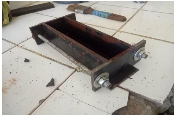
Figure III.11 Le moule 4*4*16 (laboratoire génie mécanique université Bejaia).
