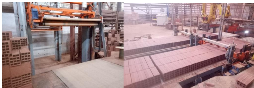
Figure.II.11. Photo montrant Chargement des briques (briqueterie tamadnine Adrar).
