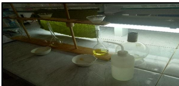
Figure III.3 La filtration (laboratoire STG cimenterie d'Adrar).
