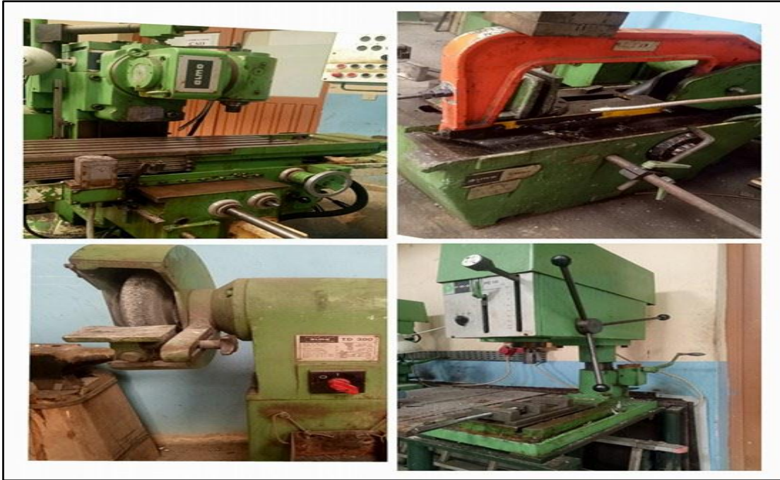
Figure III.10 Les machines pour la fabrication des moules (fraiseuse, perceuse a colonne, scie automatique, meule) (laboratoire génie mécanique université Bejaia).
