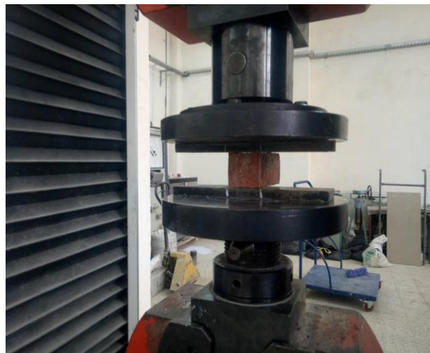
Figure III.17 Appareil de la résistance à la compression (laboratoire génie civil université Tizi ouzou).
