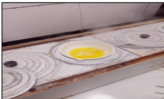
Figure III.2 Un bain marie (laboratoire STG cimenterie d'Adrar).
