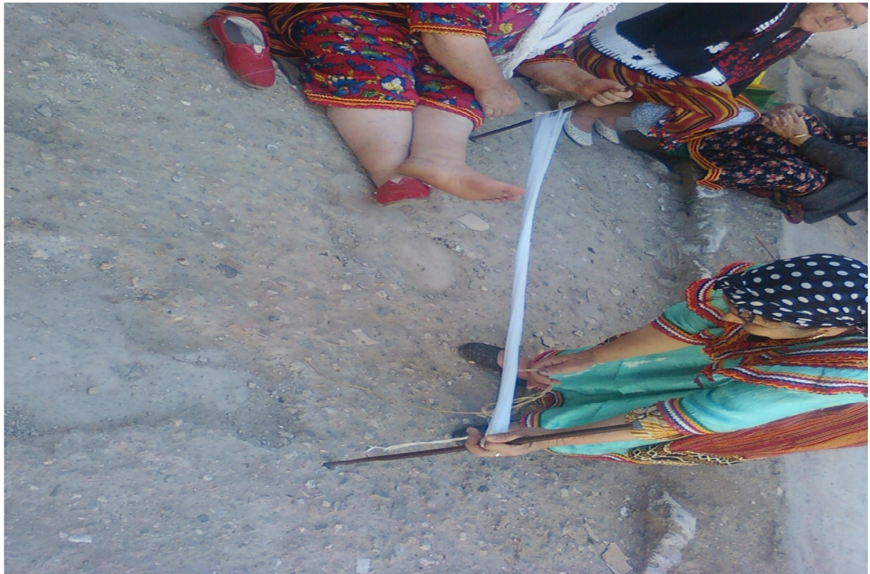
La photo N°1 : la prise de photo à la place publique aÉfir lors de l'ourdissage d'aqelmun (capuchon du burnous). Deux piquets et les fils de la chaîne destinés au tissage.
