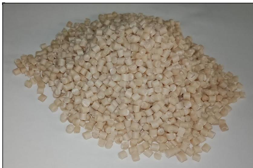
**Figure II.1:** Granulés de poly (3-hydroxybutyrate-co-3-hydroxyvalérate) (PHBV).
