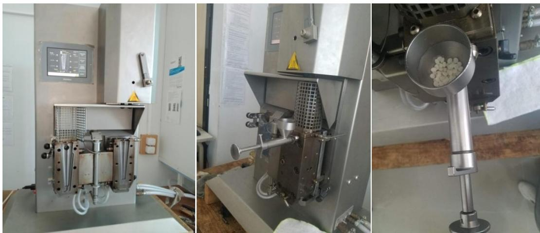
**Figure II.5:** Mini-extrudeuse bis-vis de type micro compounder DSM Xplore modèle 2005.
