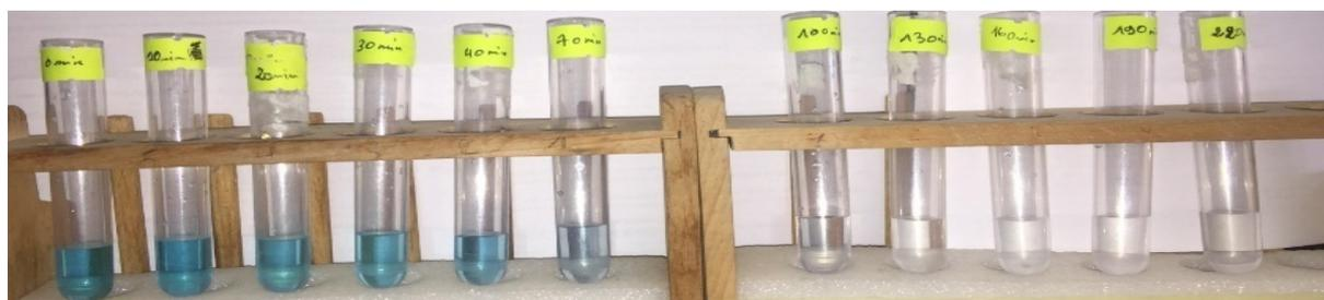
**Fig.III.111** Image de la solution bleue de Méthylène préalablement traitée avec  $\text{LaZnO}_3$  dans Visible
