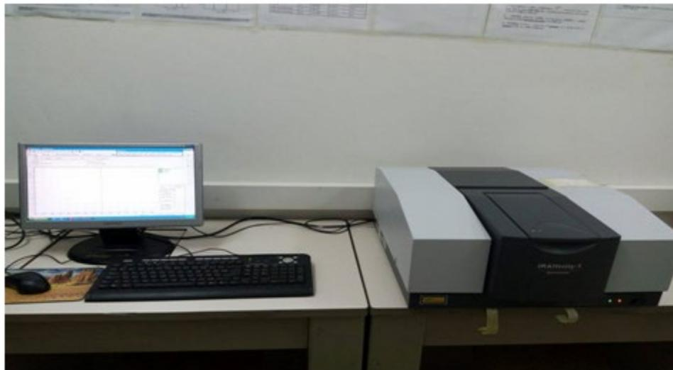
**Figure II.8 :** Spectromètre a transformé de Fourier
