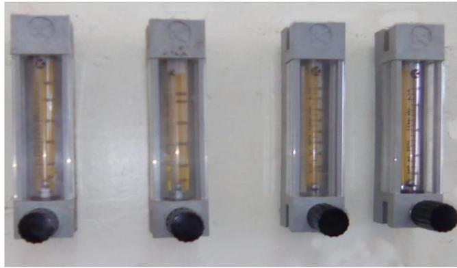
Figure III.6 : Débimètre à air utilisé (emplacement en parallèle)
