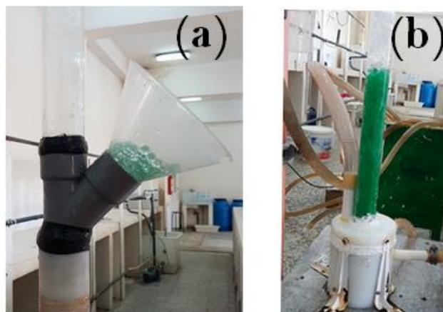
**Figure III.10** : Alimentation en phase solide
