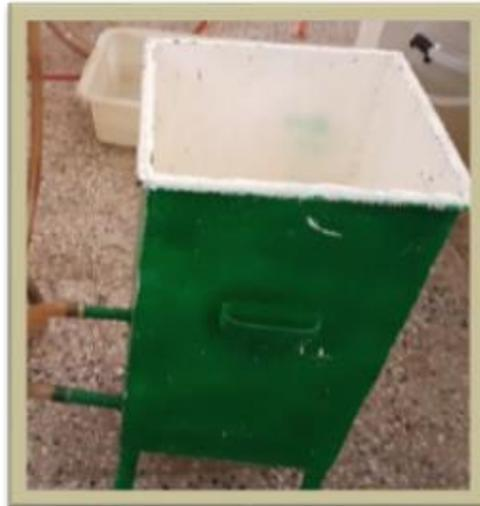
**Figure II.2 :** Réservoir d'alimentation liquide
