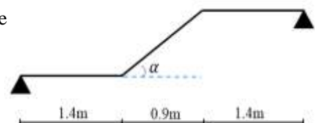
Figure 2.14. Schéma statique de la poutre brisée
