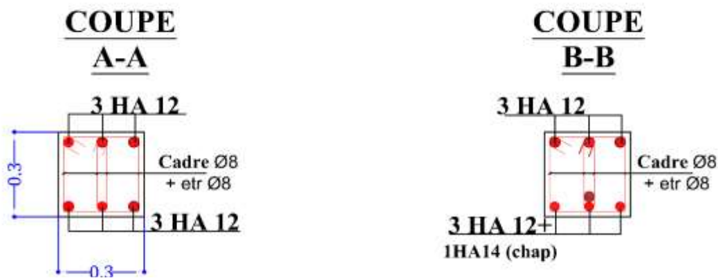
Figure 2.23. Schéma de ferrailage de la poutre brisée coupe transversal
