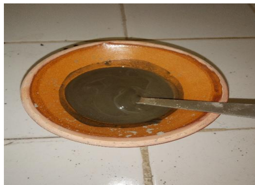
Fig II.3 : Malaxage de pâte à ciment
