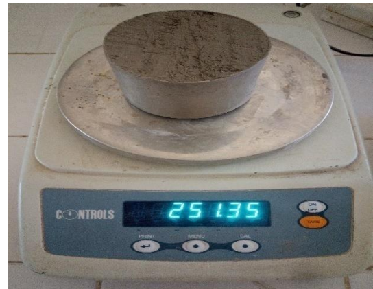
Fig II.22 : Pesée de moule avec ciment
