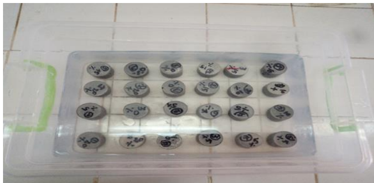
Fig II.9 : Emergence des éprouvettes dans la solution sulfurique
