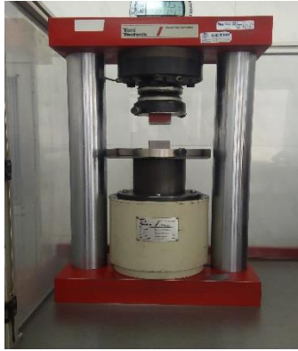
Fig II.16 : Appareil d'essai de résistance à la compression
