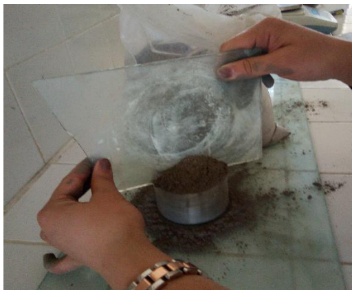
Fig II.21 : Arasement du talus
