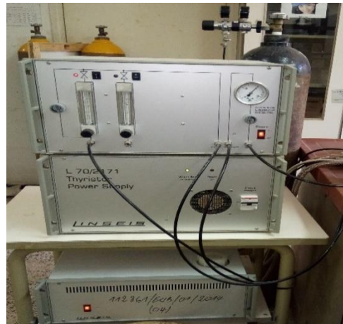
Fig II.15 : Système de refroidissement de l'appareil de thermogravimétrie
