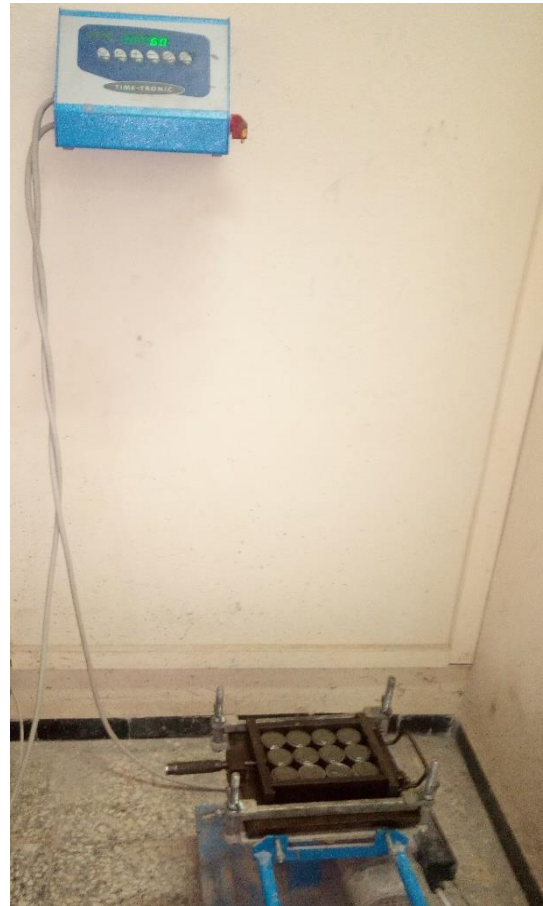
FigII.6 : Mise en place des éprouvettes à l'aide d'une table à chocs
