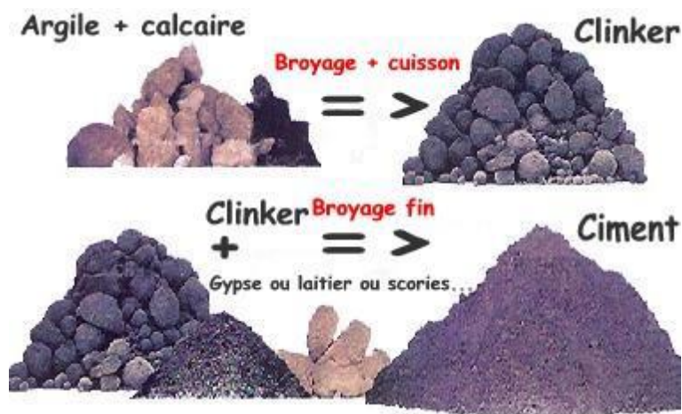
Fig I.3 : Chaîne de transformation de calcaire et d'argile en ciment [26].
