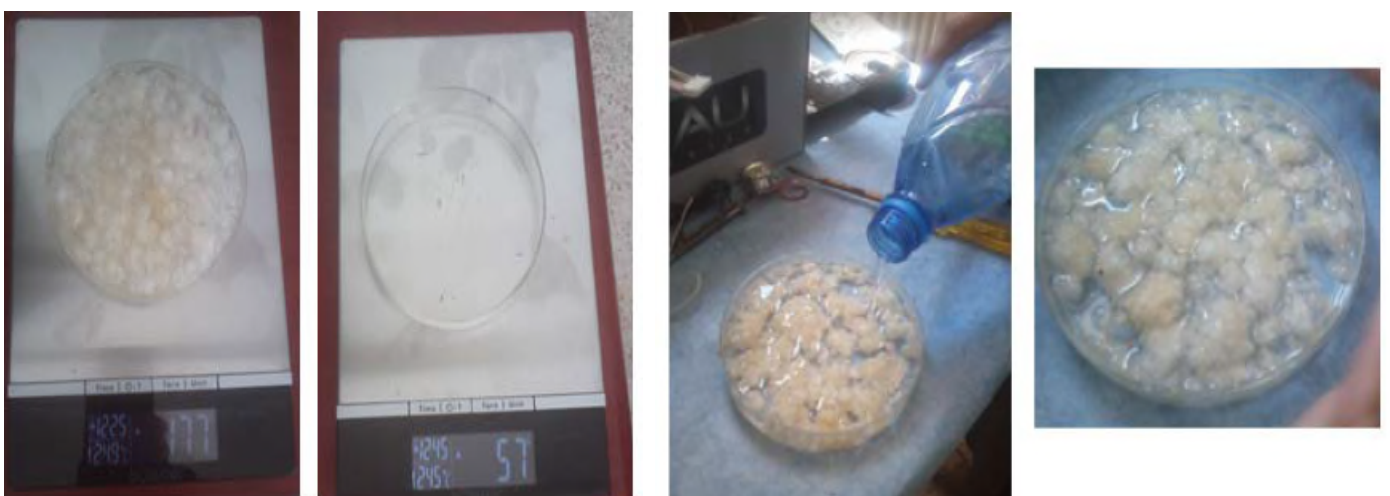
Figure 9. Réhumidification et pesée du super-absorbant après séchage rapide.
